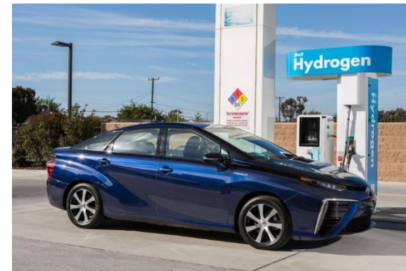
Toyota Mirai – PEMFC 114 kW
